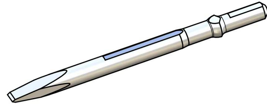
1. Зубило не должно иметь трещин, волосовин, плен, включений, выколов на хвостовых и режущих частях.
