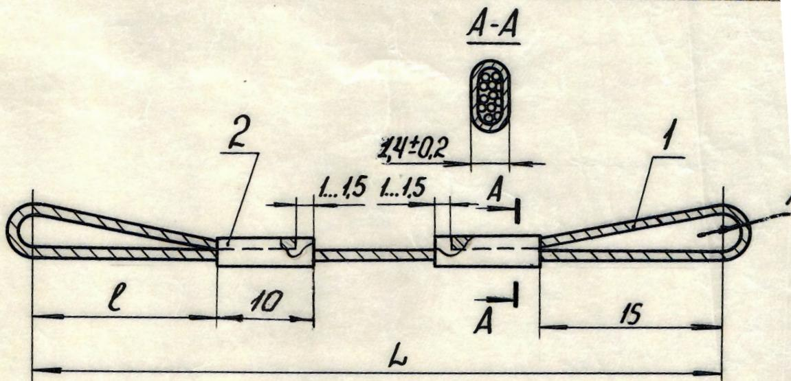
Обозначение заделки обжатием
